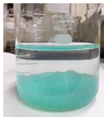
1段目の沈殿物写真 (銅のみ沈殿させた状態)
