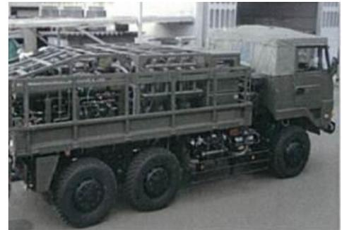
陸上自衛隊向け浄水セット・逆浸透2型
