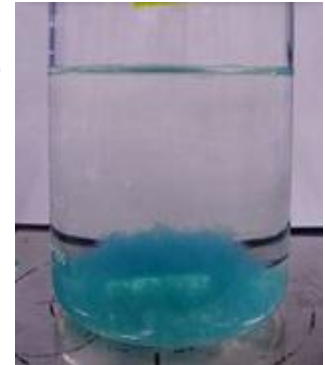
薬品の配合改善により沈殿した再資源可能な銅
