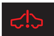
ハイブリッドシステム 異常警告灯
